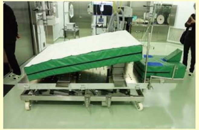
油圧式昇降 馬手術台 (材質 ベース:SUS304 テーブル:アルミ製)
